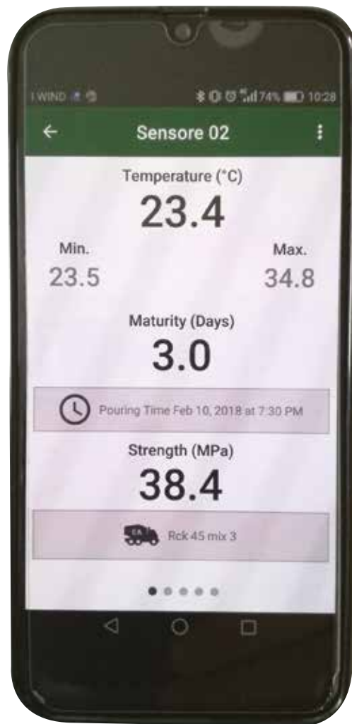
↓ Figura 5 - Schermata di visualizzazione dei dati del sensore tramite app scaricata sullo smartphone
