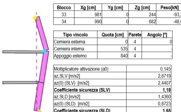
Figura 9 – Esempio di meccanismo di collasso della parete esterna. Ribaltamento nella condizione pre-intervento ( FS=0,57 ); flessione verticale nella condizione post-intervento (vincoli efficaci in fondazione e al cordolo sotto-copertura, FS=1,18 ).
