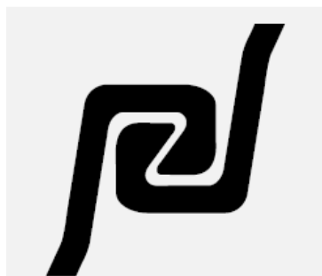
Figura 11: forma tipica del giunto longitudinale tra due palancole metalliche e giunto con profilo in poliuretano impermeabilizzante
